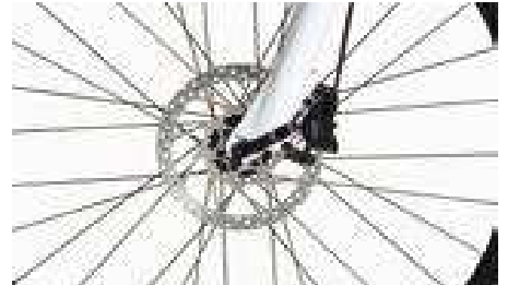
ТОРМОЗНАЯ СИСТЕМА Shimano BR-M 446, гидравлическая, диаметр диска 180 / 160 мм.
