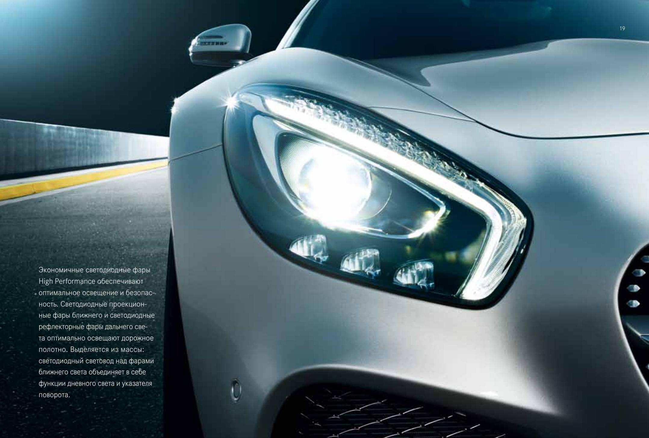
Экономичные светодиодные фары High Performance обеспечивают оптимальное освещение и безопасность. Светодиодные проекционные фары ближнего и светодиодные рефлекторные фары дальнего света оптимально освещают дорожное полотно. Выделяется из массы: светодиодный световод над фарами ближнего света объединяет в себе функции дневного света и указателя поворота.
