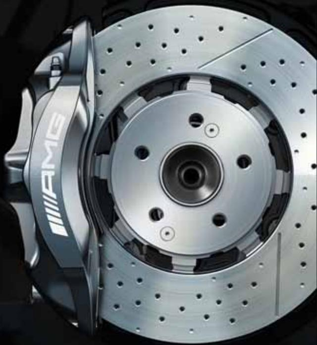
Высокоэффективная композитная тормозная система AMG с красными суппортами, эксклюзивно для Mercedes-AMG GT S. Диаметр впереди 390 мм, сзади 360 мм, вентилируемая и перфорированная. Рассчитана на повышенную мощность и силу торможения.
