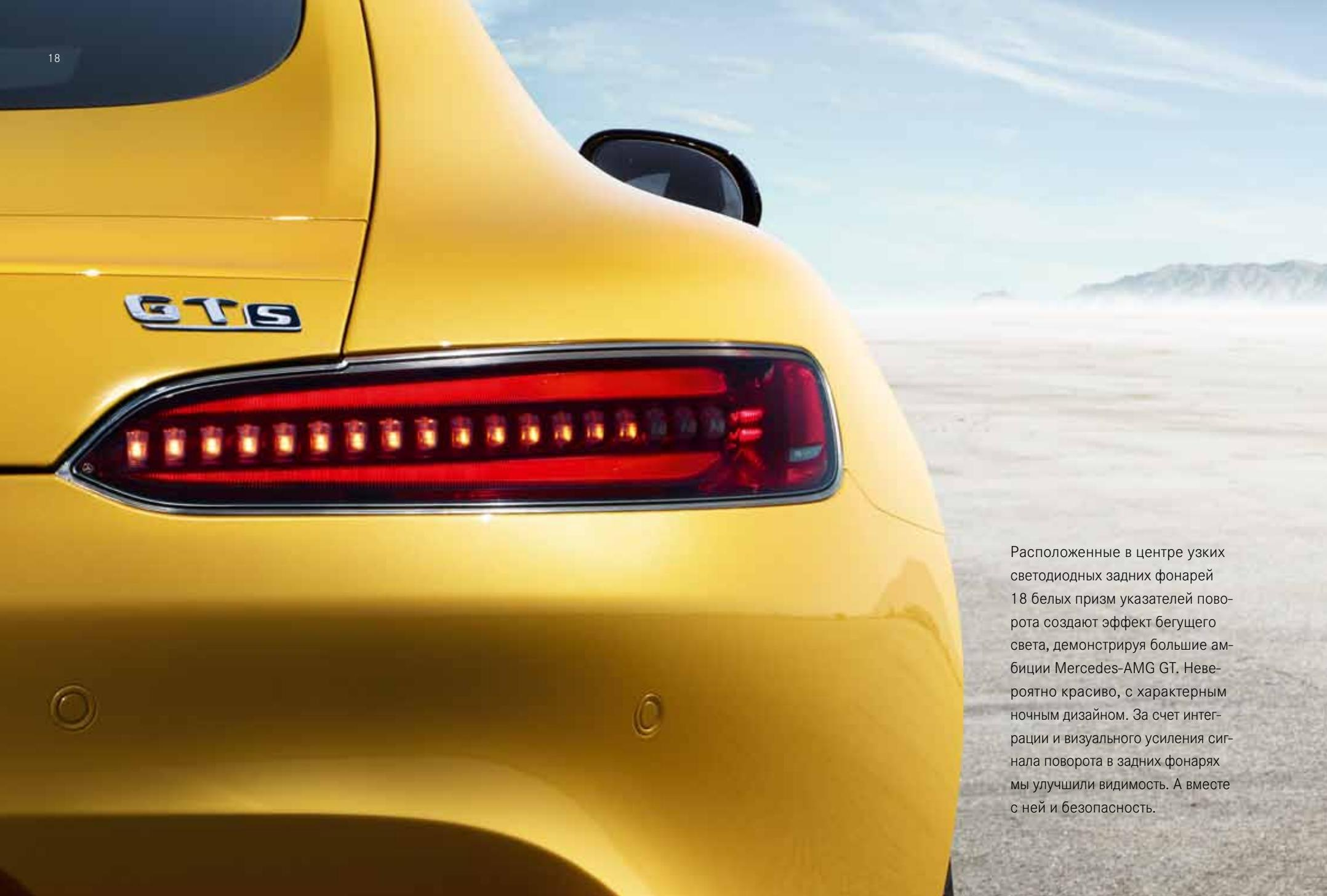
Расположенные в центре узких светодиодных задних фонарей 18 белых призм указателей поворота создают эффект бегущего света, демонстрируя большие амбиции Mercedes-AMG GT. Невероятно красиво, с характерным ночным дизайном. За счет интеграции и визуального усиления сигнала поворота в задних фонарях мы улучшили видимость. А вместе с ней и безопасность.
