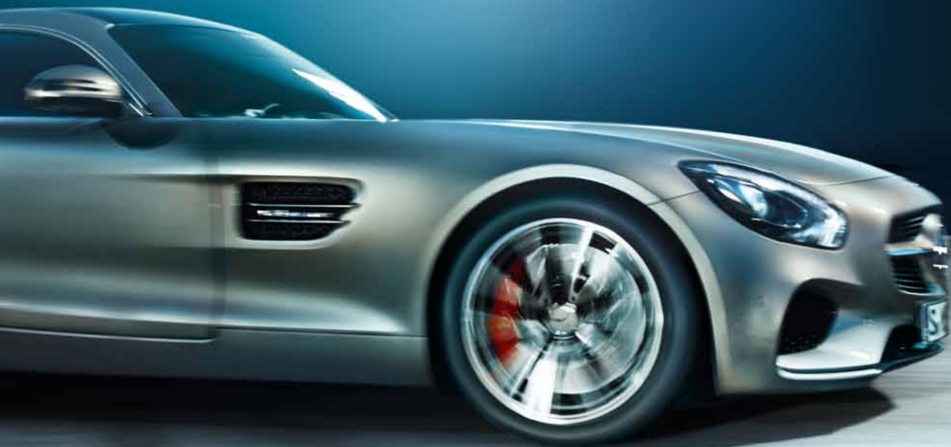
Серийная высокоэффективная композитная тормозная система AMG для Mercedes-AMG GT, диаметр впереди и сзади 360 мм, вентилируемая и перфорированная. Максимально короткий тормозной путь, четкая точка сопротивления и высокая надежность.
